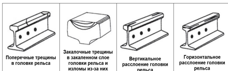
Рисунок 1 – Примеры дефектов рельсов
