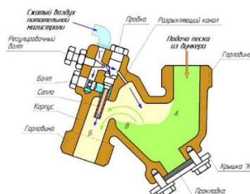
Рисунок 2 – Форсунка песочницы ФПЗ-64 электровоза 2ЭС6
