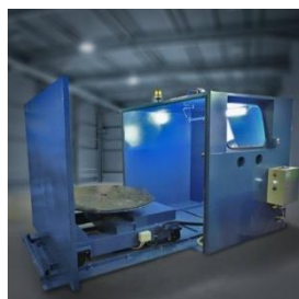
Рисунок 2 – Автоматическая камера для обдувки тяговых электродвигателей
