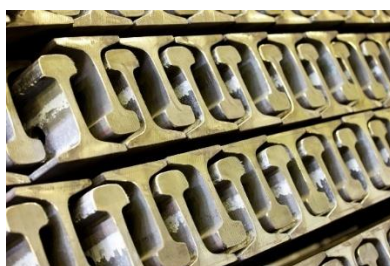
Рисунок 1 – Категория рельсов ДТ370 (вязко-прочные)
