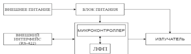
Рисунок 3 – Структурная схема лазерного триангуляционного дальномера
