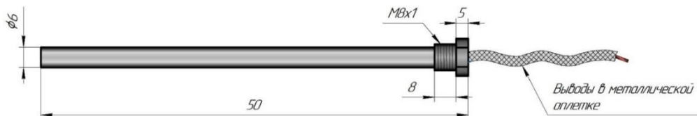
Рисунок 4 – Внешний вид патронного нагревателя ЭПВ6х50 для монтажа в корпус форсунки песочницы
